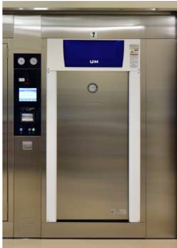
高圧蒸気滅菌器 第一種圧力容器
